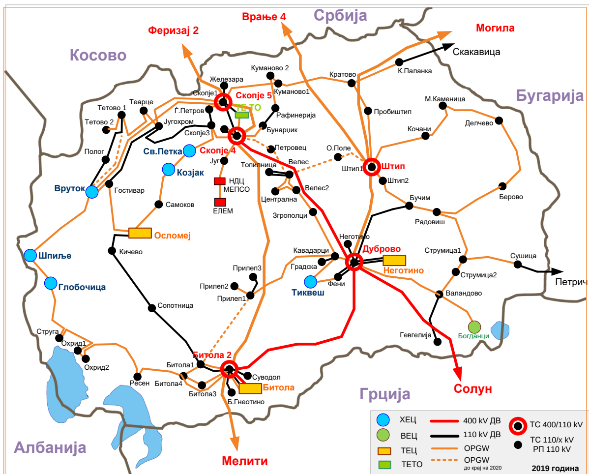
Слика 11. OPGW заштитно јаже по далекуводите на преносната мрежа
